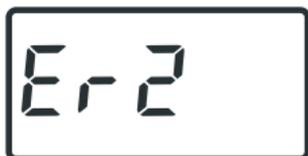
Este error ocurre cuando inserta una tira de prueba usada o dañada en el medidor.
