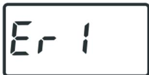
El medidor se está usando fuera del rango de temperatura para la medición (10-40°C).
