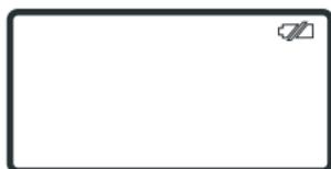
Si el ícono de la batería parpadea, significa que no puede hacer más pruebas. En este caso, reemplace la batería con una nueva.
