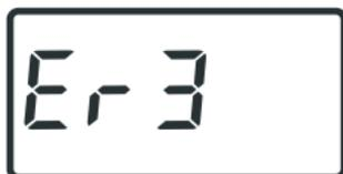
Este error ocurre cuando la tira de prueba es retirada durante la prueba. Cuando aparece el mensaje ER3, el medidor pitará y se apagará después de 3 segundos.
